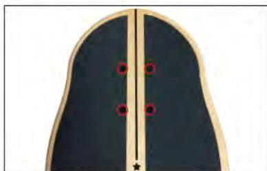
SLIDE TRUCK を付ける為の穴は、通常のポジションに加え、1cm リア寄りにも、あらかじめ穴(赤丸印箇所)を開けているため、好みや状況に応じて簡単にセッティングを変更する事が可能。
