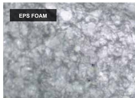
EPS は、発泡スチロールの粒子であり、明確なセル壁がなく、互いに結合しています。
