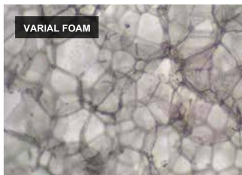
VARIAL FOAM のセルの大きさの均一性、セル間の間隙空気量の少なさが見て取れます。
