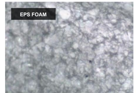
EPSは、発泡スチロールの粒子であり、明確なセル壁がなく、互いに結合しています。
