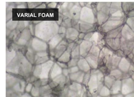
VARIAL FOAM のセルの大きさの均一性、セル間の間隙空気量の少なさが見て取れます。
